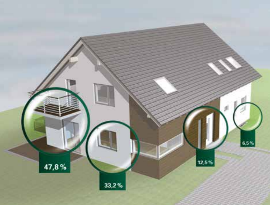
einbruchgefährdete Bereiche am Einfamilienhaus
